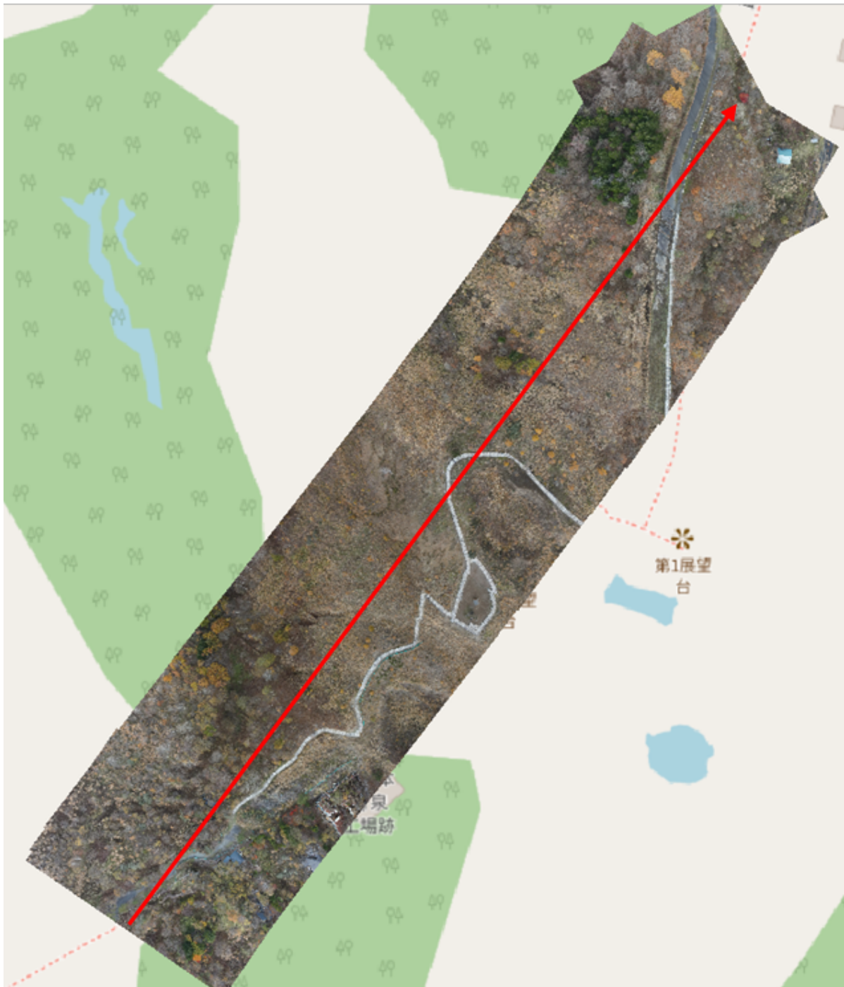
図 1 UAV 取得画像の確認用補助アプリケーションの処理結果 赤線は UAV の飛行コース。UAV で連続撮影した画像に抜けがないことが確認できる。
