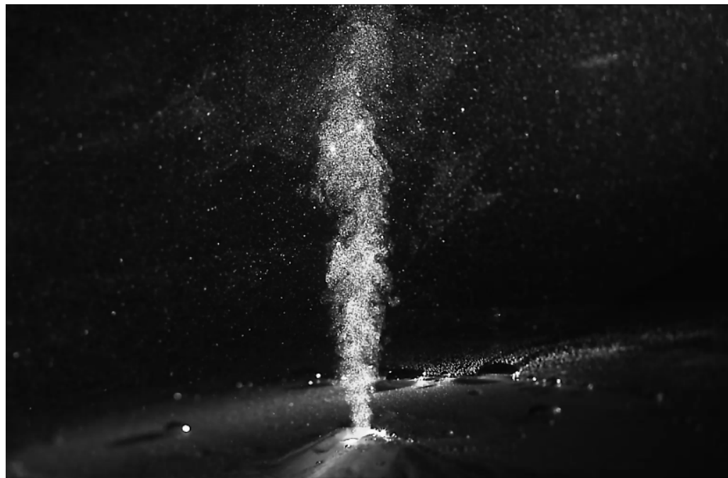
図 2-61 水槽を用いた火山模型周りの密度流れ場の可視化。水槽を用いた密度流れ場の可視化実験を行い、PIV (Particle Image Velocimetry) により、輝点の運動を追跡して流速分布を計測する。
