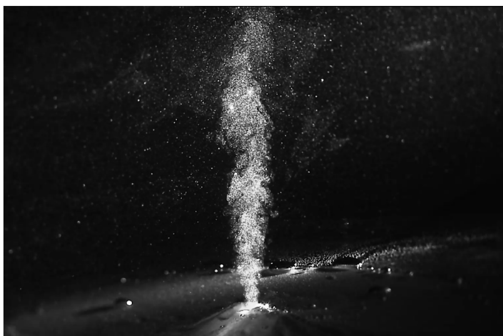
図 9 噴煙の大気中の上昇による気象場の検討のために、水槽を用いて火山模型周りの密度流れ場を可視化した。PIV (Particle Image Velocimetry) により、輝点の運動を追跡して流速分布を計測する。
