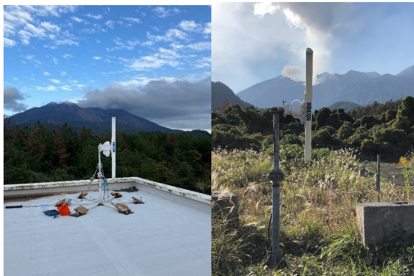
図 2-21 桜島観測所（左）と黒神観測室（右）の船舶用レーダの空中線部
