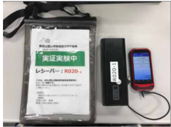
図 3-75 登山道他に設置するレーザー（ケース、バッテリー、スマートフォン）
