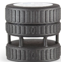
FT205 （FT Technology 社製） 風速，風向を最大 10Hz で測定．内臓電子コンパスで方位を自動補正
