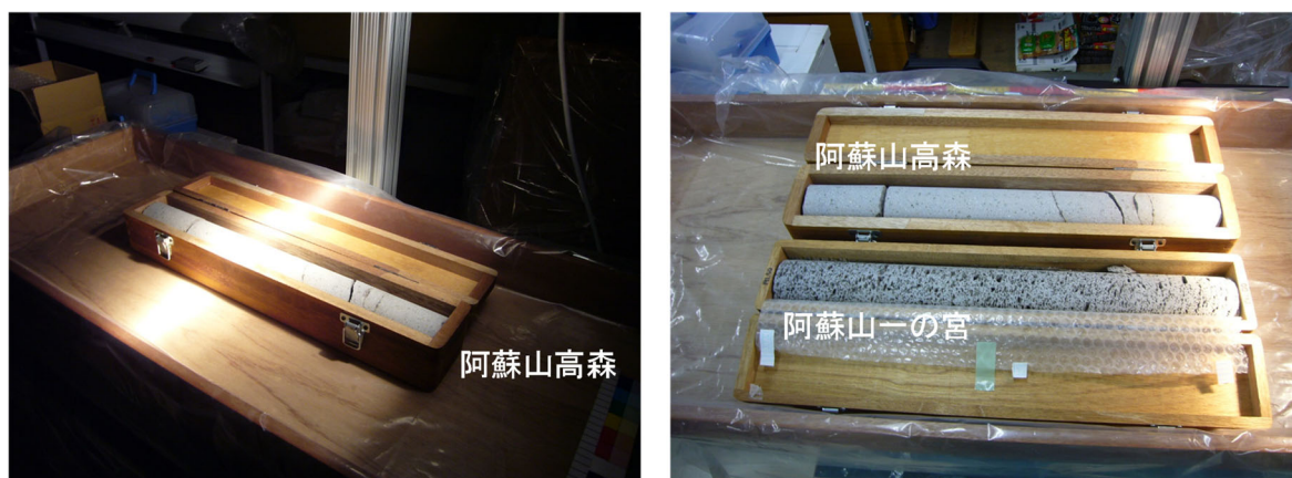
図 2-31 コア箱用外箱（内寸：420 mm×1,100 mm×90 mm）に孔底コア用の 50 cm コア箱を搭載し大型試料スキャンステージに搭載しスキャンを実施している様子．左図：コア箱を縦方向に 1 箱整列し格納、右図：コア箱を横方向に 2 箱整列し格納．
