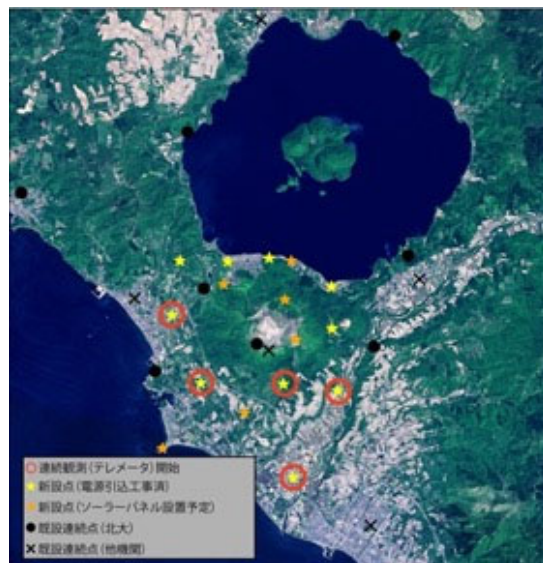
図 7 有珠山に整備した GNSS 観測網。赤丸で示した観測点にはテレメータ装置を導入し連続観測を開始し、準リアルタイム測位が実現した。
