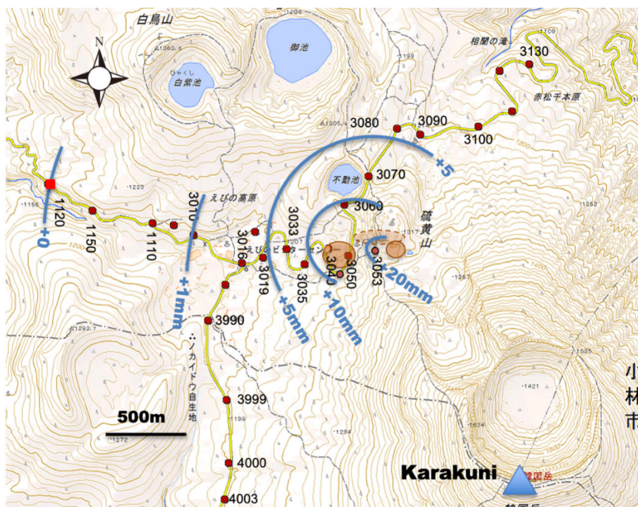
図 32 えびの高原～硫黄山区間の水準路線と 2023 年 3 月から 2024 年 4 月までの隆起量 (BM3040 を除く)。2018 年 4 月から活発化した噴気領域や、これまでの水準測量から推定された圧力源の水平位置も同時に示す。国土地理院電子地形図 (タイル) を使用した。
