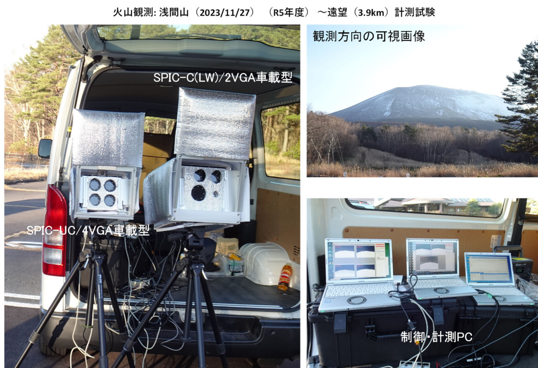
図 2-22 SPIC-UC/4VGA 車載型、SPIC-C(LW)/2VGA 車載型の観測の様子（浅間山の噴煙観測、2023 年 11 月 27 日）。浅間山の北北東 3.9 km、標高 1,374 m の浅間園駐車場より観測。
