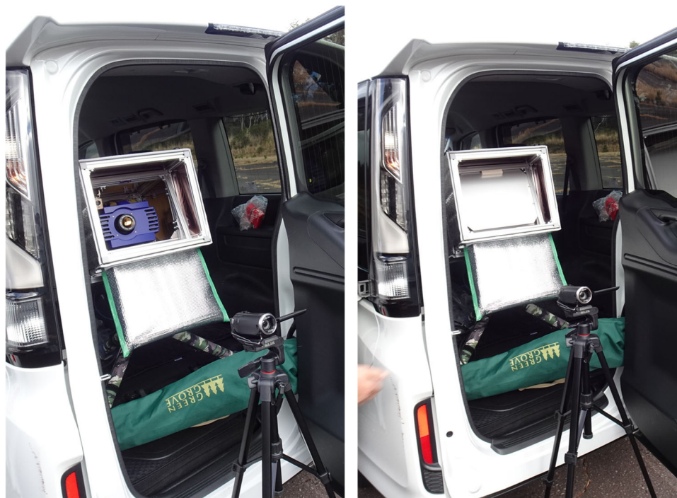
図 2-14 浅間山試験観測での SPIC 用シャッター機構、黒体と冷却型遠赤外線マルチバンドカメラ。左図：シャッター開時、右図：シャッター閉時。
