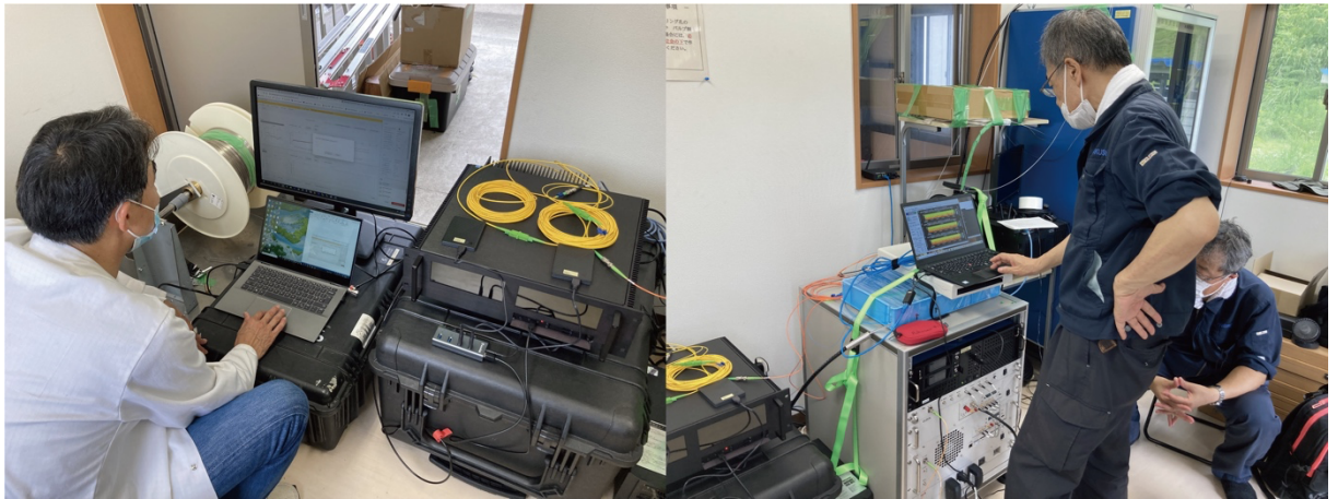
図2 分散型音響センシングシステム（DAS）と位相シフト光干渉法によるセンサを用いた振動観測システム（光センサシステム）の比較観測を行った。左右の写真はそれぞれ DAS と光センサシステムの信号処理装置の操作風景である。
