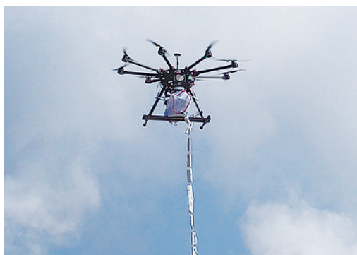
▲ 図2 箱根山における火山ガス採取の様子。黄色の物質は自然硫黄。火山ガスを毎月採取し、化学組成と同位体比の分析を行っています。
