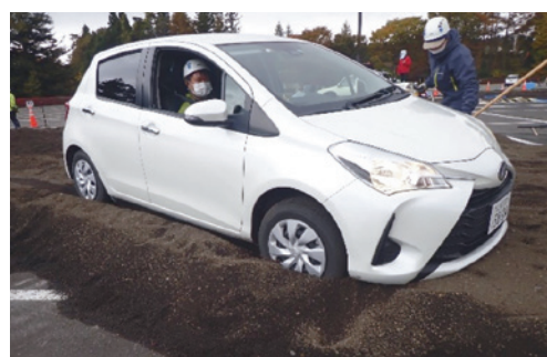
写真2 富士山北麓で山梨県が2021年に実施した火山灰上車両走行実験
