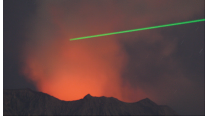
写真2 桜島の火山灰をとらえるライダーのレーザー光線
