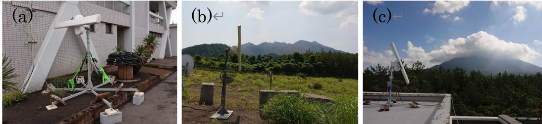
図 37 複数台の船舶レーダによる噴煙柱の定点観測。(a) 京都大学防災研究所桜島ハルタ山観測点に設置された FRS コーポレーションの船舶レーダ。(b) 京都大学防災研究所桜島黒神観測点に設置された北海道大学の船舶レーダ。(c) 京都大学防災研究所桜島火山観測所屋上に設置された鹿児島大学・光電製作所の船舶レーダ。
